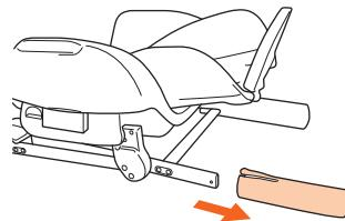
5 本体両側面と底面の緩衝材を取りはずして使用します。
